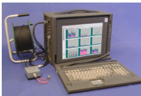
Рисунок 1.5 – Многоканальный масштабируемый комплекс АЭ на базе промышленного переносного компьютера производства «Интерюнис»
