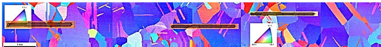
Рисунок 3.19 – EBSD карта микроструктуры поверхности испытания на образце, темным следом отмечены места нанесения царапин (по 2 мм каждый)
